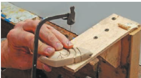
Мал. 4.5. Виготовлення деталей способом випилювання за допомогою різних інструментів
