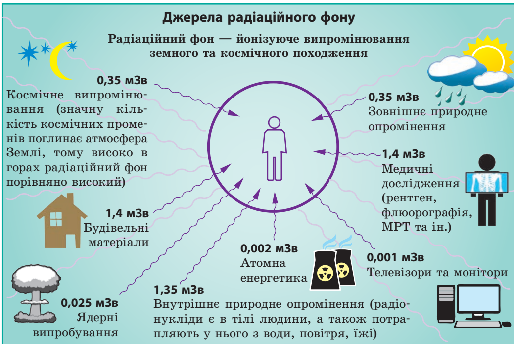
Рис. 25.5. Середні еквівалентні дози йонізуючого випромінювання, які отримує людина протягом року від деяких джерел радіації
