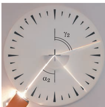
Рис. 12.5. Якщо світло падає зі скла в повітря, в разі збільшення кута падіння кут заломлення наближається до 90^\circ , а яскравість заломленого пучка зменшується
