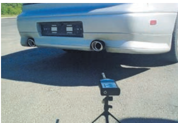
Рис. 5. Вимірювання рівня шуму від глушника автомобіля
