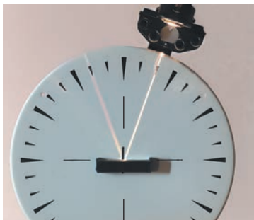
Рис. 11.3. Зі зміною кута падіння світла змінюється й кут відбивання. Кут відбивання щоразу дорівнює куту падіння
