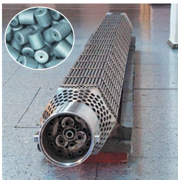
Рис. 27.1. ТВЕЛ (тепловидільний елемент) — частина реактора, пристрій, у якому міститься ядерне паливо (таблетки діоксиду Урану)
