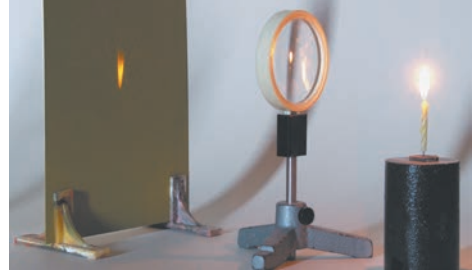
Рис. 15.1. Отримання зображення полум'я свічки за допомогою збиральної лінзи
