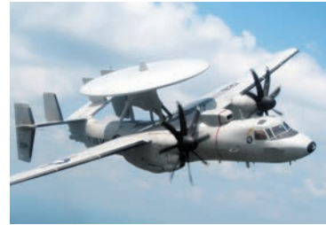
Рис. 21.4. Сучасний «літаючий радар» може виявити літак супротивника на відстані 540 км
