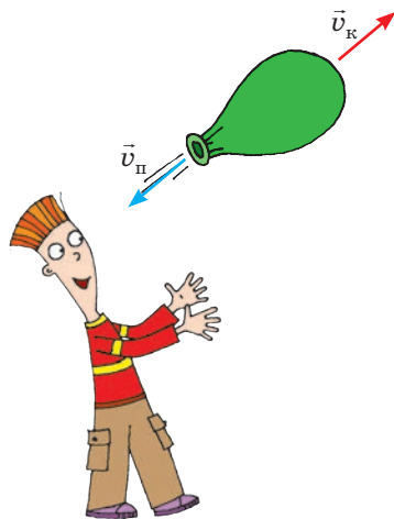
Рис. 37.1. Рух кульки під дією повітря, що виривається з отвору, — це реактивний рух
