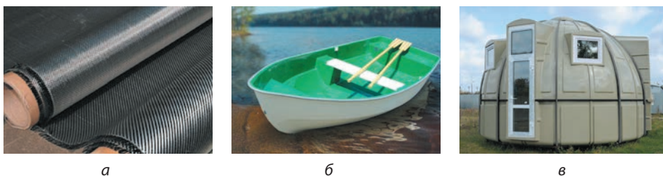
Мал. 40.1. Використання композитних матеріалів: вуглецеву тканину (вуглеволокно) (а) використовують для армування деталей велосипедів та автомобілів, зі склопластика виготовляють корпуси байдарок та невеликих човнів (б) і навіть цілі будинки (в)
