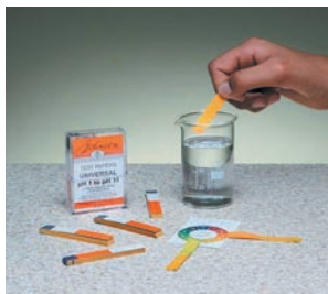
Мал. 11.3. Універсальним індикатором визначають приблизне значення рН
